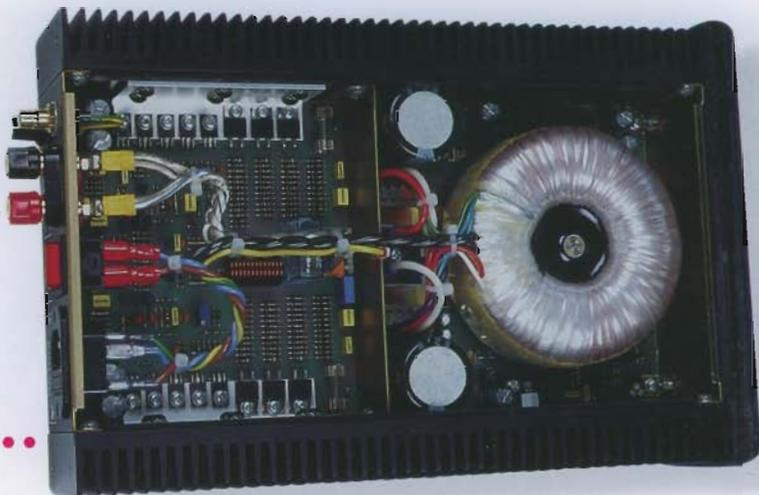
**Výkonový zesilovač 200 W/4 Ω** osazený výkonovými MOS-FETy je monaurální konstrukce. Je vybaven regulací citlivosti a má nesymetrický vstup – pozlacený cinch konektor s teflonovou izolací.
