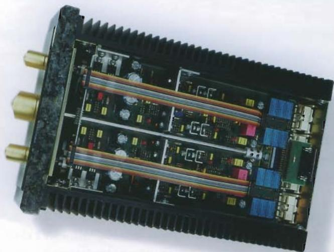
**Řídicí zesilovač DPA 111 s externím napájecím zdrojem DPA 114** je opět bimonaurální koncepce. Oddělení napájecí části od vlastního zesilovače umožnilo docílit vynikajícího odstupu rušivých signálů.
