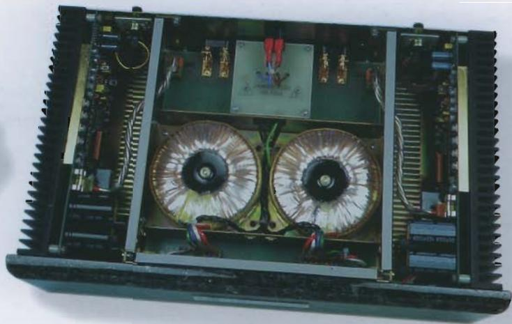
**Bipolární výkonový zesilovač 2 x 120 W/4 Ω** je bimonaurální konstrukce. Je vybaven regulací citlivosti a ve standardním provedení má nesymetrické vstupy – pozlacené cinch konektory s teflonovou izolací. Na zakázku je možné symetrické osazení vstupů (XLR).
