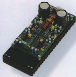
**Výkonový zesilovač 2 x 100 W/4 Ω** osazený výkonovými MOS-FETy je bimonaurální konstrukce. Je vybaven regulací citlivosti a ve standardním provedení má nesymetrické vstupy – pozlacené cinch konektory s teflonovou izolací. Na zakázku je možné symetrické osazení vstupů (XLR).
