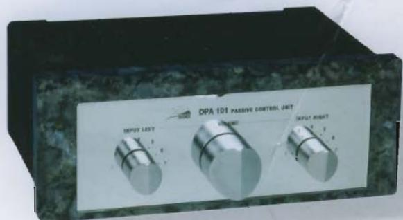
**Pasivní řídicí jednotka** neobsahuje žádný aktivní (zesilující) prvek. Má sedm vstupů a z důvodu minimalizace odstupů mezi levým a pravým kanálem je přepínání vstupů řešeno dvěma nezávislými přepínači. Regulátor hlasitosti je osazen kvalitním potenciometrem ALPS (10 k $\Omega$ ). Vstupní a výstupní konektory cinch jsou zlacené.
